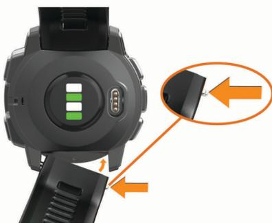
**POZNÁMKA:** Zkontrolujte, zda je řemínek řádně připevněn. Osička musí zacvaknout do příslušných otvorů na zařízení.
