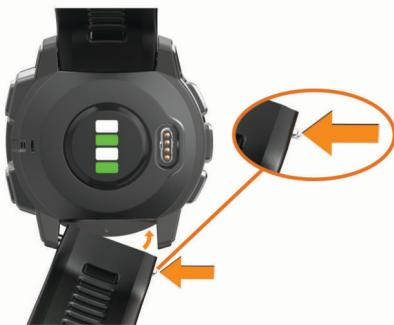
**POZNÁMKA:** Zkontrolujte, zda je řemínek rádně připevněn. Osička musí zavaknout do příslušných otvorů na zařízení.
